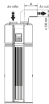
3 Výstup napojený na potrubí
