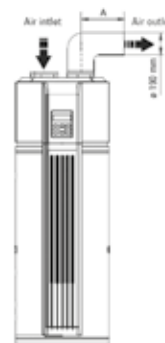
3 Výstup napojený na potrubí
